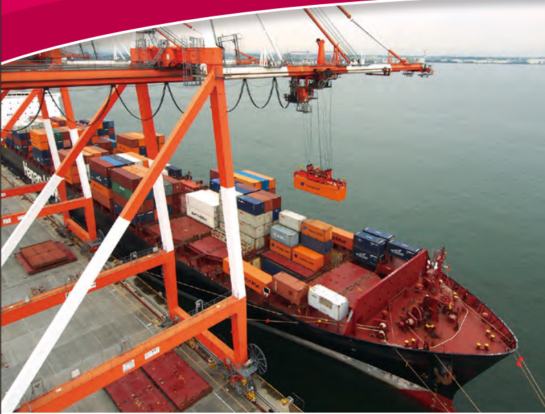
ガントリークレーンで荷役中のコンテナ船
