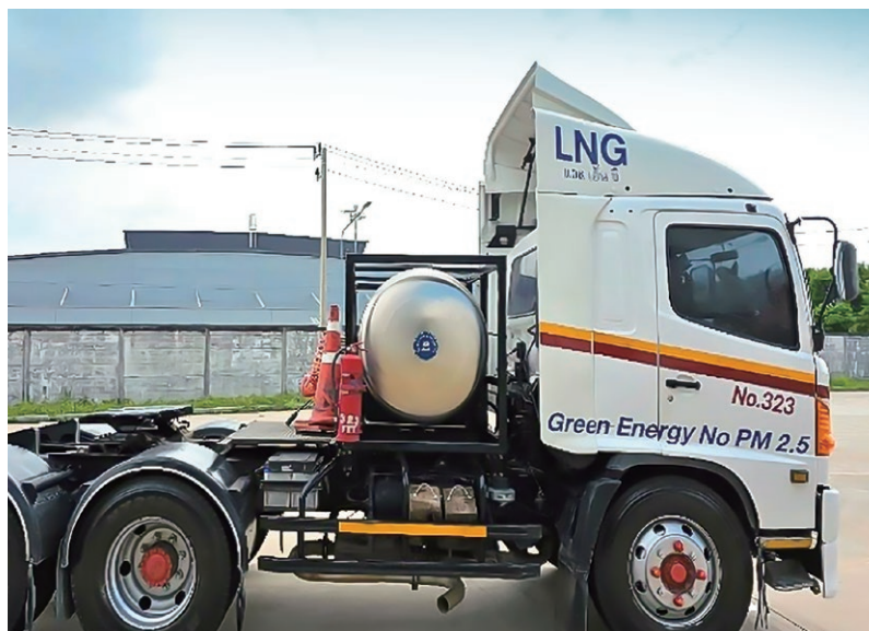
CNGタンクの代わりにLNGタンクを搭載したトラック
