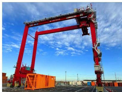
西浜コンテナヤードでは、今回のRTG導入に伴い、コンテナの5段積み蔵置が可能となります。現在進めている専用ヤードの整備が完了すれば、蔵置能力は従来の約600TEUから、本格稼働時には約2.3倍の約1,400TEUまで大幅に拡大します。インランドコンテナデポとしての機能を大幅に強化することで、多様化するお客様の物流ニーズに迅速かつ柔軟に対応してまいります。
